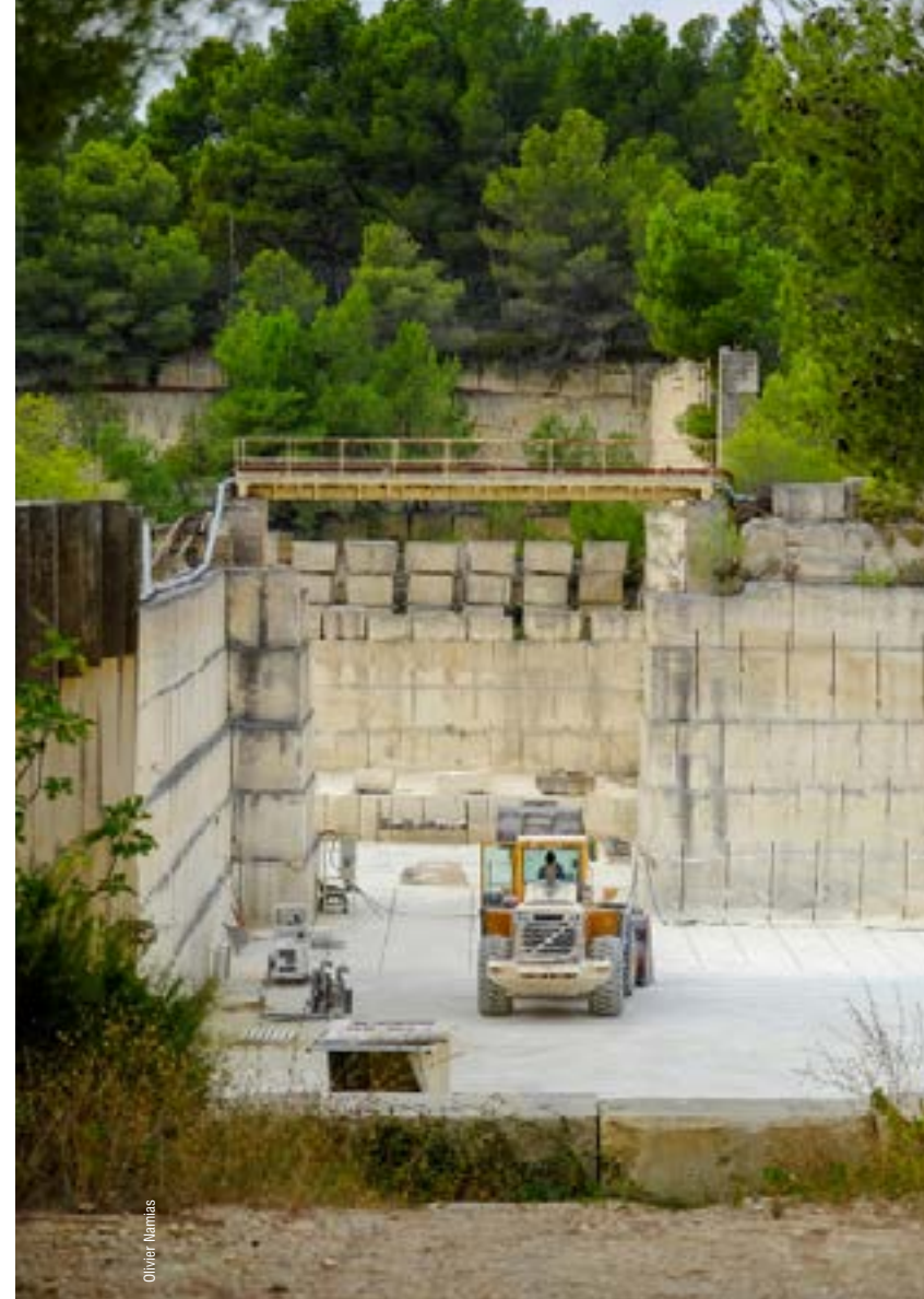
« Les blocs de pierre peuvent peser jusqu'à 16 t. Leur manutention est réalisée à l'aide de chariots élévateurs, grues ou derricks. Ils sont ensuite transportés jusqu'à l'atelier de transformation. En photo, la carrière de Fontvieille (Bouches-du-Rhône). »
