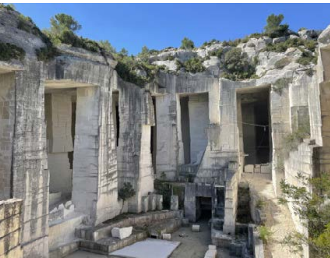
« Les pierres naturelles sont extraites essentiellement en carrières à ciel ouvert (les bancs peuvent se situer à 2-3 m ou 20-30 m de profondeur), plus rarement, en galerie souterraine. Ici, la carrière Sarragan (Bouches-du-Rhône). »
